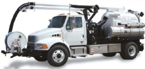
Equipos Vactor de 15 Yardas Cúbicas ( camión de 2 ejes ) para trabajos pesados y grandes, donde se requiere la más alta capacidad de recolección y potencia en el lavado, en vías normales o amplias.
